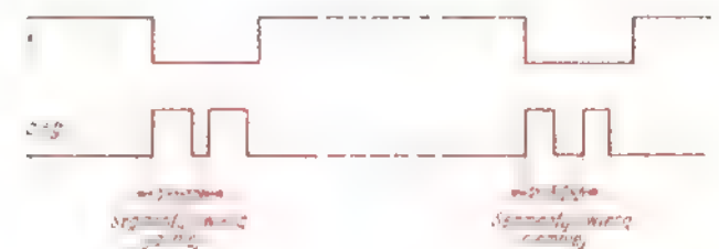
Rys. 11. Przebiegi impulsowe na wejściach segmentów wyświetlacza
